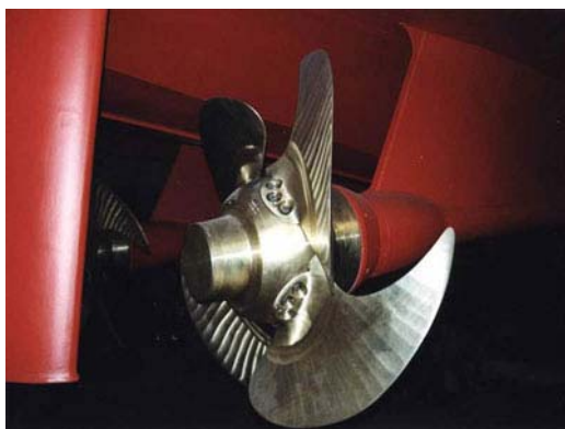
HELICE CORRECTAMENTE PROTEGIDA
