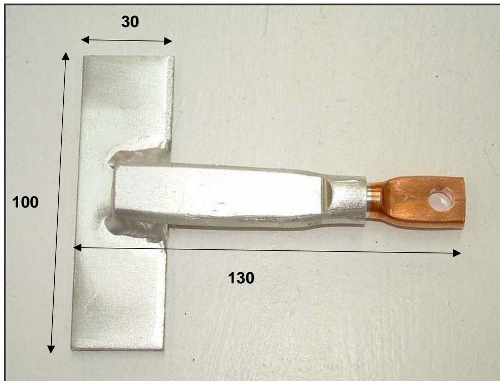
Para instalá-lo: deverão soldar-se os extremos de 30mm da placa de alumínio a uma caverna do barco
